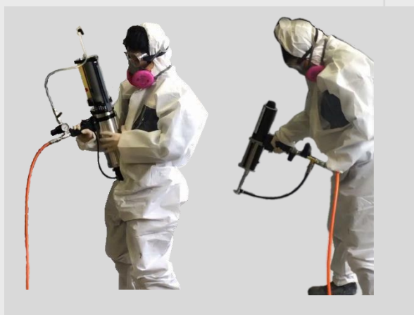
200ml カートリッジガン (写真右) 1500ml カートリッジガン (写真左)
